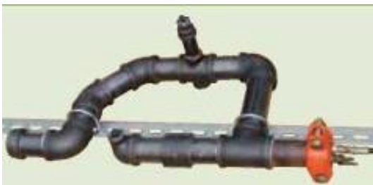
球墨鑄鐵螺紋式另件的破壞實驗 (2")
