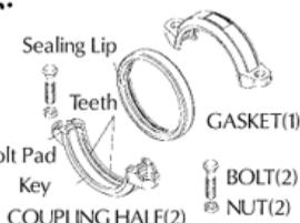
Achten Sie darauf, daß die mitgelieferte Dichtung zweckentsprechend ist. Unsere Standard- EPDM-Dichtung (Typ A) mit violettem Farbcode ist für nasse und trockene (ölfreie Luft) Sprinkleranlagen bis zu 175 psi (1200 kPa) in der Umgebungstemperatur gedacht. Für weitere Anwendungen wenden Sie sich bitte an Ihren Händler für das richtige Dichtungsmaterial.
