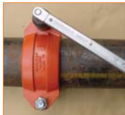
務必遵照下表 「安裝扭力」鎖緊螺絲
